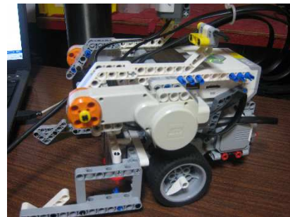
AポートとDポートに接続したモータの ホームポジション
